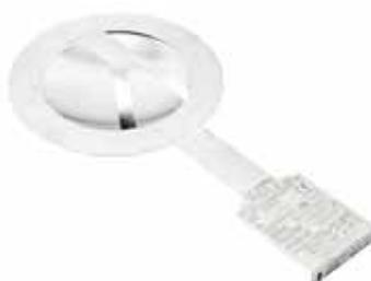
Разрывная мембрана **Donadon SDD** типа **Y90** получена с помощью технологии NSNanoscored и представляет собой мембрану с компрессионной нагрузкой или нагрузкой обратного действия с микронасечками по окружности.
