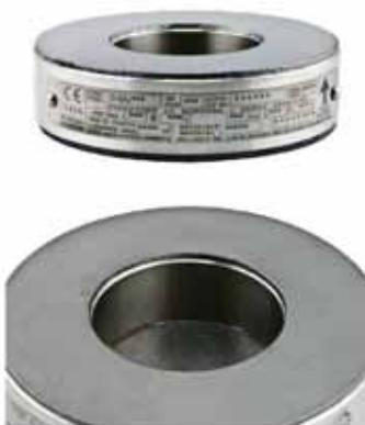
Разрывная мембрана Donadon SSD типа GA - это графитовая мембрана, установленная в кольце из нержавеющей стали, которое может устанавливаться непосредственно между фланцами.
