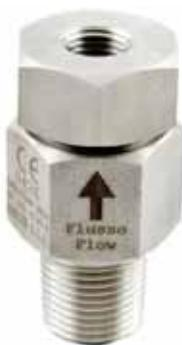
Герметичные блоки **Donadon SSD** типа **SU/M** состоят из резьбового соединения, состоящего из двух частей, и содержащего калиброванную разрывную мембранию. Разрывная мембра на помещена в резьбовой и герметичный контейнер. Эти блоки были специально разработаны для того, чтобы сделать более легкой и надежной установку в оборудование с мембранными небольшого, размера. Что может представлять сложность при отсутствии специализированного персонала.
