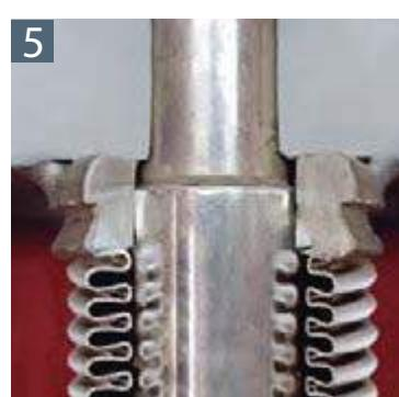
Металлическое уплотнение между штоком и крышкой с ограничителем хода в открытом положении является ключевым элементом безопасности, поскольку позволяет избежать выброса штока и предотвращает утечку в случае повреждения сильфонов.
