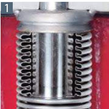
Цельносварные многослойные сильфоны из нержавеющей стали защищены от кручения и рассчитаны на 10000 операций. Они обеспечивают более высокий уровень безопасности и позволяют избежать возникновения утечки в случае разрушения уплотнения.
